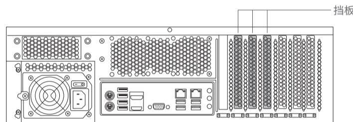
3 将解码单元插入一体机中，请务必让解码单元的金手指对准底面的卡槽；使用螺钉将解码单元的两端固定在一体机上。
